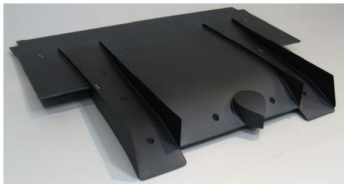
Bild 2: Komplex geformtes Composite aus Aluminium-Sandwichbauweise: Rear-Diffuser für KTM X-Bow (Unteransicht)
