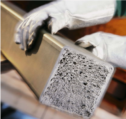
Abb. 1: Leichtbau-Portal einer Werkzeugmaschine – Verbundbauteil aus Aluminiumschaum und Stahl.
